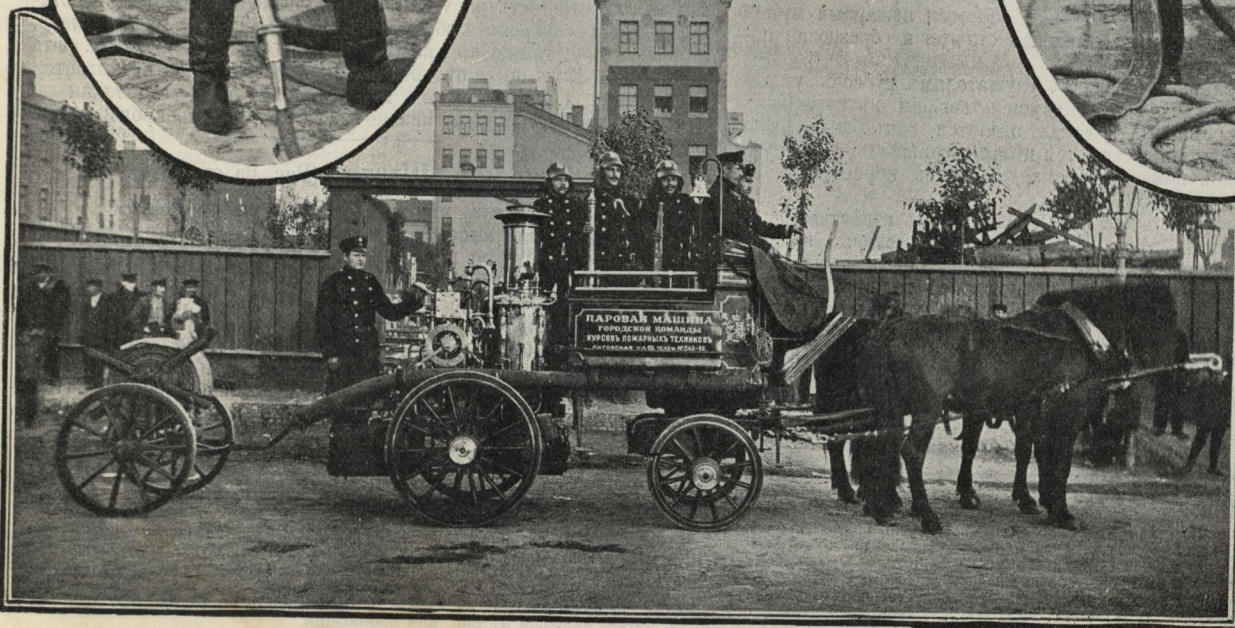
Паровая машина на три рукава. Струя воды достает до 7-го этажа Образцовая пожарная команда въ С.-Петербурѣ. По фот. В. Полонскаго, авт. «Нивы».
